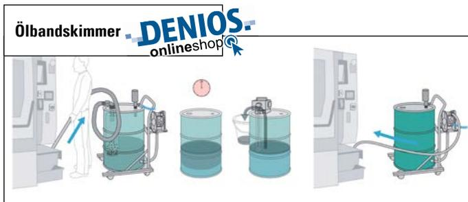
**Kombinierter Einsatz:** PumpOut saugt Kühlwasser aus einer Maschine und trennt dabei Partikel von der Flüssigkeit. Ein Ölbandskimmer auf der 2"-Öffnung des Behälters schöpft das Öl von der Oberfläche ab. Dann wird die gereinigte Flüssigkeit in die Maschine zurückgepumpt.
