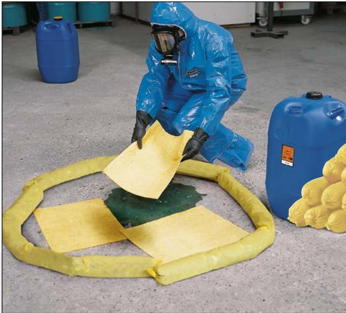
**SPEZIAL** Schlangen zur Begrenzung von ausgetretenen Gefahrstoffen bei Unfällen und Bindevliesmatten **SPEZIAL** zur anschließenden Aufnahme der Flüssigkeiten
